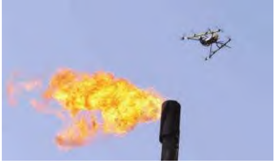
«سايبير هوك» تستخدم الطائرات المشغلة عن بعد في إجراء عمليات التفتيش على الهياكل الخطرة والتي يصعب الوصول إليها كالمداخن المشتعلة ومناطق التخزين تحت المنصات
